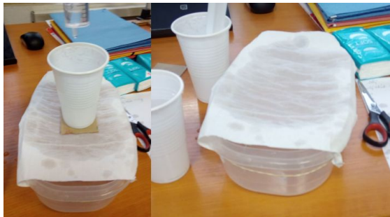
Obr. 1: Experimentální uspořádání včetně stříkačky pomalu přidávající vodu do kelímku vlevo.
